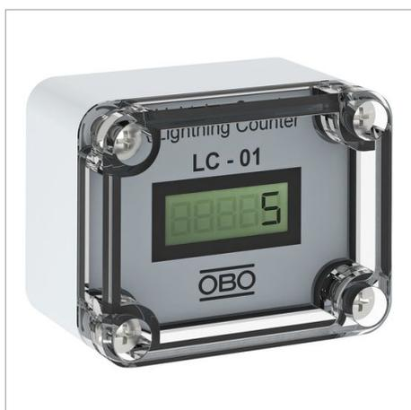
Der Blitzstromzähler LC-01 erfasst Impulsströme und speichert diese fest ab. Somit findet eine ständige Kontrolle statt, ob ein Blitz in das Blitzschutzsystem eingeschlagen hat.
